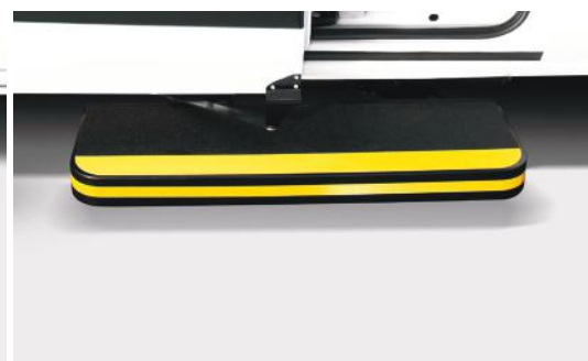
Trittstufe bereits komplett ausgefahren, wenn die Tür halb geöffnet ist.
